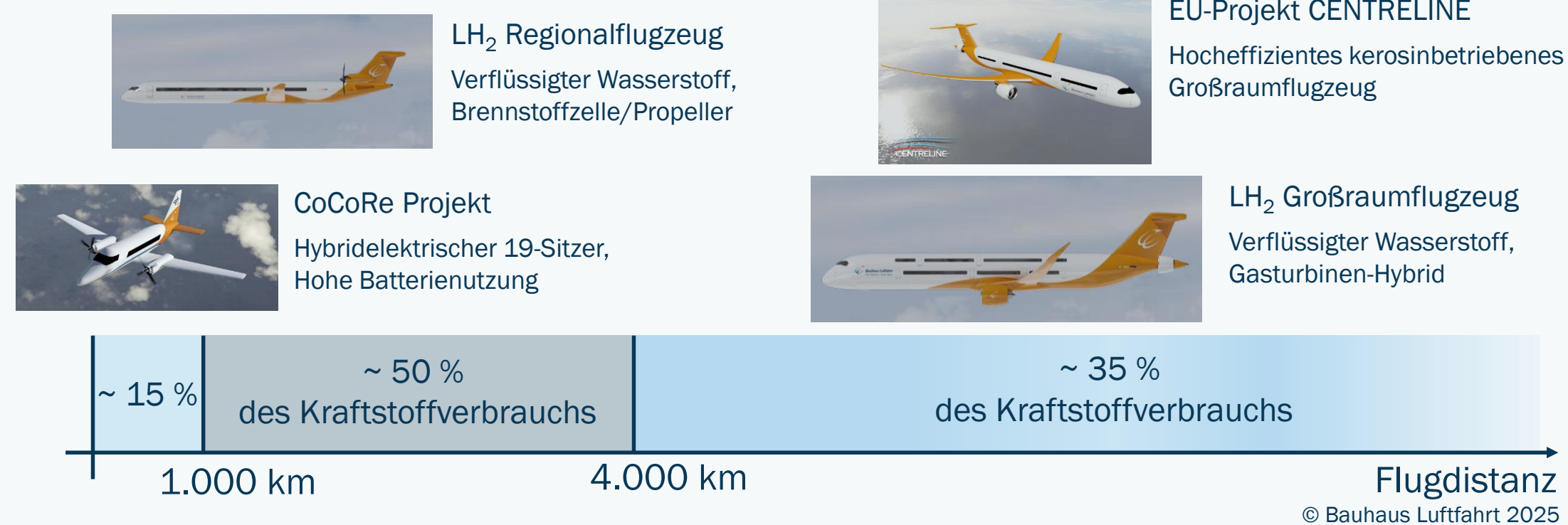
Abb. 1-5 Konzeptionelle Entwürfe für elektrische, mit Kerosin und Wasserstoff betriebene Flugzeuge verschiedener Reichweiten. Im Luftverkehr werden für den Großteil des Energiebedarfs auch in Zukunft flüssige Kraftstoffe benötigt.
