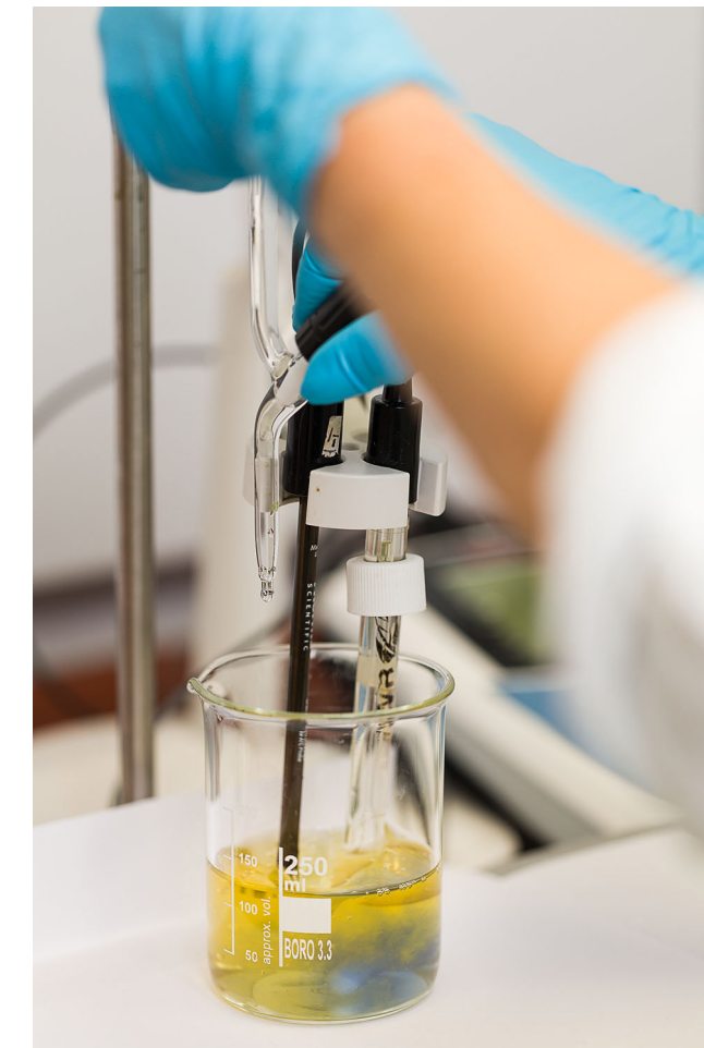
Abb. 7-4 Farbumschlag bei der Titration zur Bestimmung der Säurezahl (© Jan Gutzeit)
