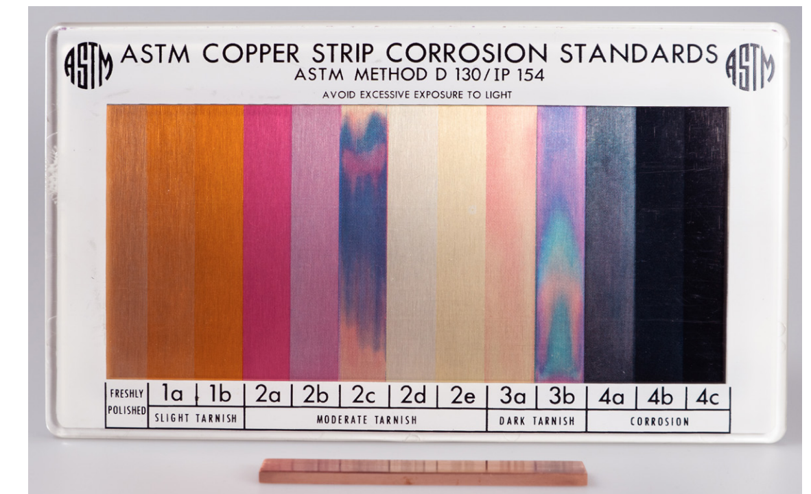
Abb. 7-3 Kupferstreifen vor der Referenzskala für den Test zur Korrosion auf Kupfer (© Rico Ehrentraut, DBFZ)
