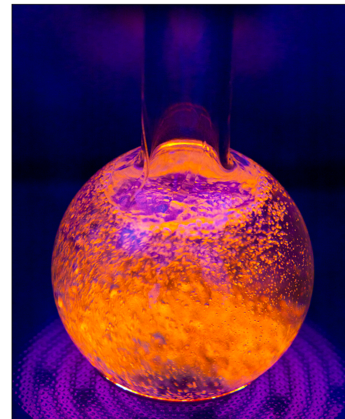
Abb. 7-2 Kolben mit Kraftstoff während der Siedekurvenbestimmung (© Paul Trainer, DBFZ)
