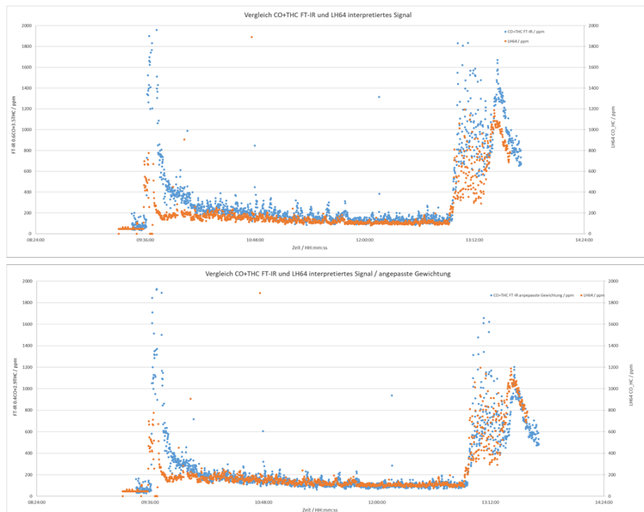
Abbildung 15: Vergleich zwischen Summensignal und Sensorsignal, oben mit alten Gewichtungsfaktoren, unten mit angepassten Gewichtungsfaktoren für den Sensor LH64
