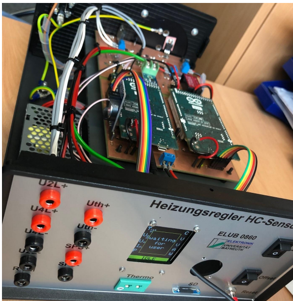
Abbildung 76: Digitale Elektronik zur Regelung auf konstante Sensorbetriebstemperatur sowie zur Aufnahme und Weiterverarbeitung des Sensorsignals und entsprechender Sekundärsignale (z. B. Typ K Thermoelement)
