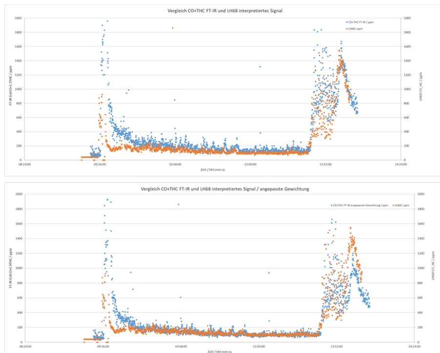
Abbildung 16: Vergleich zwischen Summensignal und Sensorsignal, oben mit alten Gewichtungsfaktoren, unten mit angepassten Gewichtungsfaktoren für den Sensor LH68
