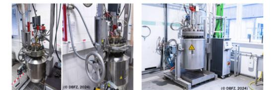
Abb. 5: Rührkesselreaktoren (10-L und 100-L) (© DBFZ, 2024)
