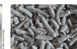
Abb. 4: Erzeugte Biokohlen aus Maisspindeln
