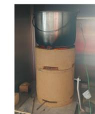
Abb. 1: Naturzugkocher im Prüfstand
