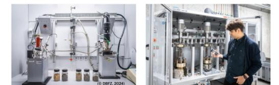
Abb. 4: Rührkesselreaktoren (0,5-L) und Hochdruck-Multibatchreaktoranlage (2-L) (© DBFZ, 2024)
