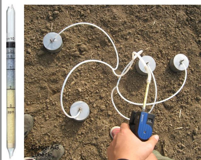
氨挥发测定装置：捕获装置、手泵等
