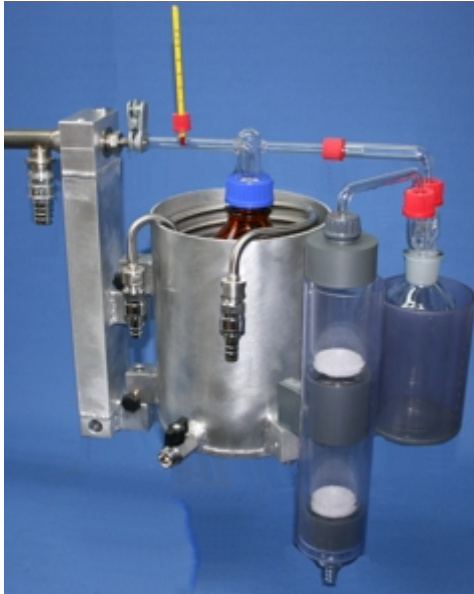
Abbildung 18: Aufbau zur Dioxin- / Furanmessung [Werksbild Paul Gothe GmbH Bochum, www.paulgothe.de ]
