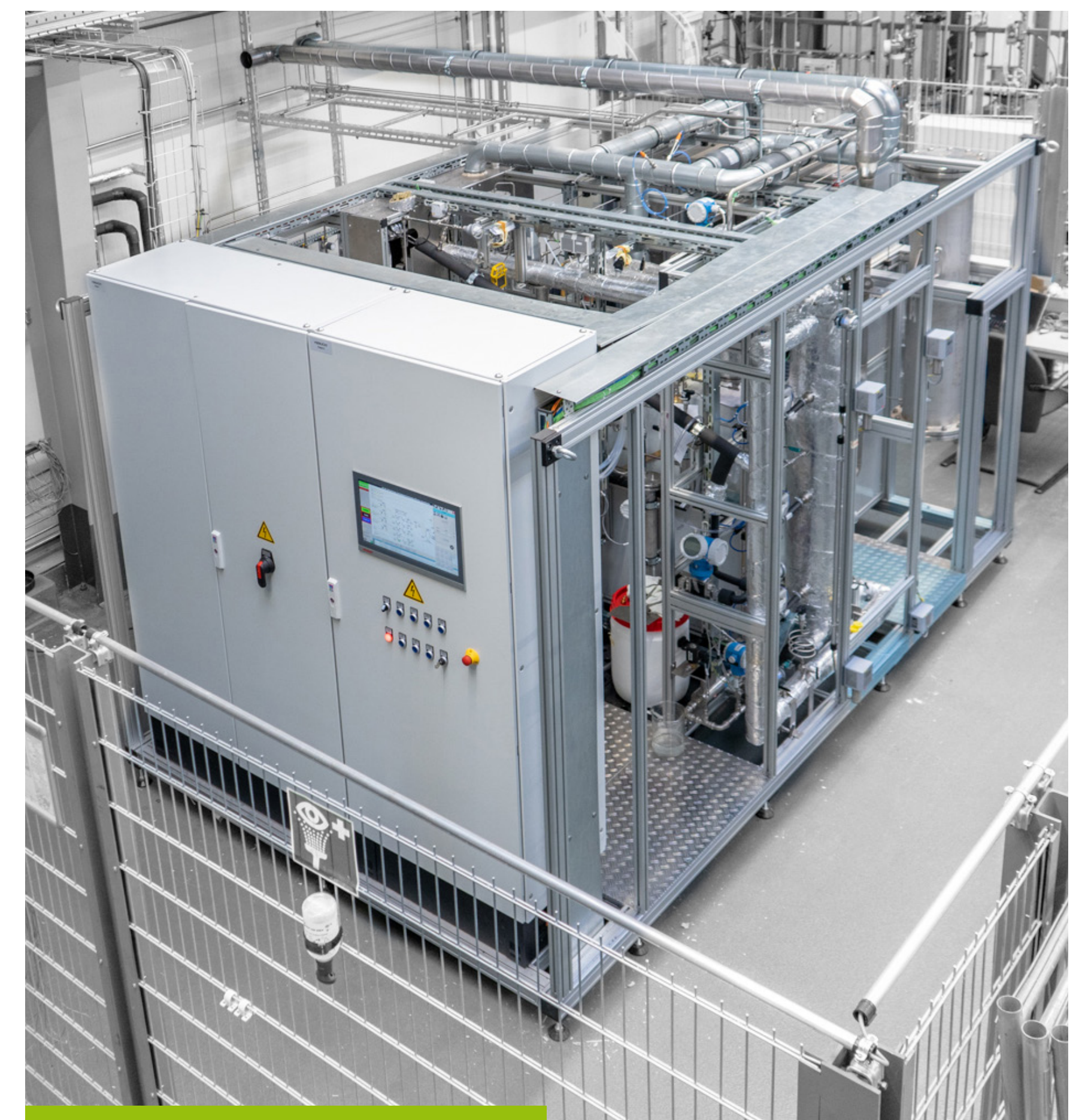
Abb. 1: Methanisierungsmodul in der Pilotanlage mit zwei Adsorberbehältern und einem Methanisierungsreaktor
