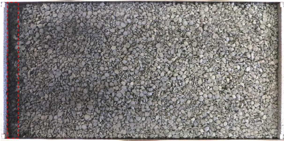
Abb. 19 Katalysatorbett im Plattenreaktor nach der Methanisierung (Ansicht von oben, Gasflussrichtung von links nach rechts); die Probennahme erfolgte am Anfang des Katalysatorbettes als Durchschnittsprobe über die Breite des Reaktors innerhalb des roten Rahmens (Bild: M. Schlüter)
