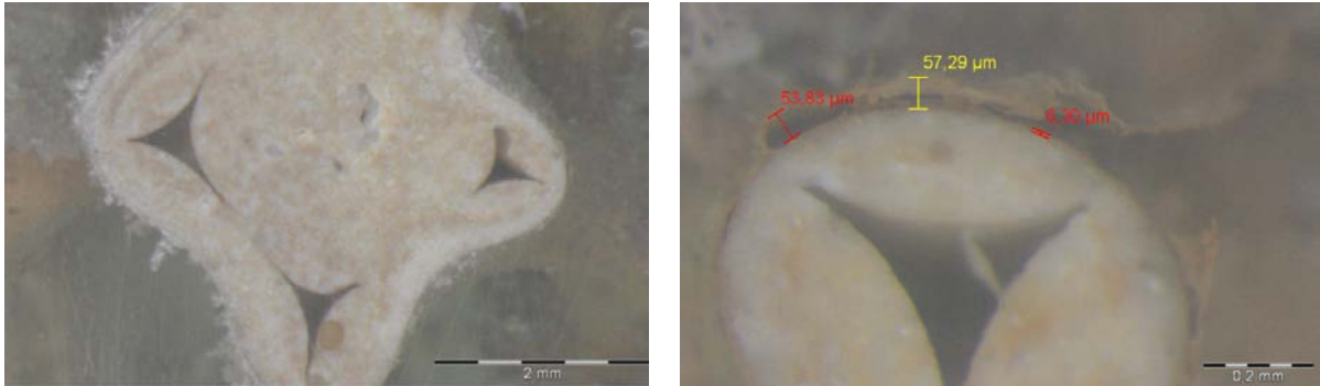
Abbildung 21: Lichtmikroskopische Aufnahmen vom Querschnitt des gealterten Wandkatalysators
