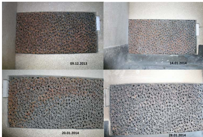
Abbildung 48: Fotografien des Wandkatalysators ( MnO_x/Al_2O_3 -Schwamm) nach Feldeinsatz im Kaminofen über 75 Tage
