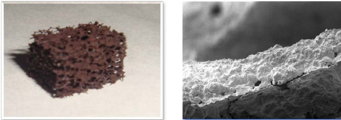
Abbildung 9: Schwammreplika bestehend aus Nickelferrit (links) und REM Aufnahme der Probe (rechts)
