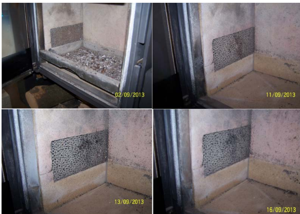
Abbildung 36: Ausgewählte Fotos der Wandkatalysatoren bei der durchgeführten Alterung unter Praxisbedingungen (Vorführkaminofen der Firma Specht) für 728 h reale Betriebszeit
