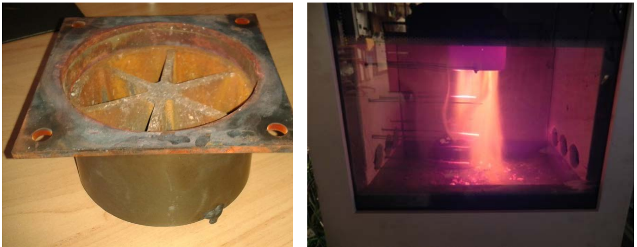
Abbildung 37: Fotografien des MnO_x/SiC -Monoliths als Down-Stream-Rostkatalysator (links: nach Versuchsende, rechts: im Betrieb)
