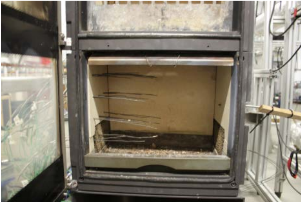
Abbildung 35: Fotografie des Versuchsaufbaus mit katalytisch aktivierten Schwämmen ( MnO_x/Al_2O_3 , Größe: 90 \times 200 \times 20 mm) im unteren Brennraum des xeos X8
