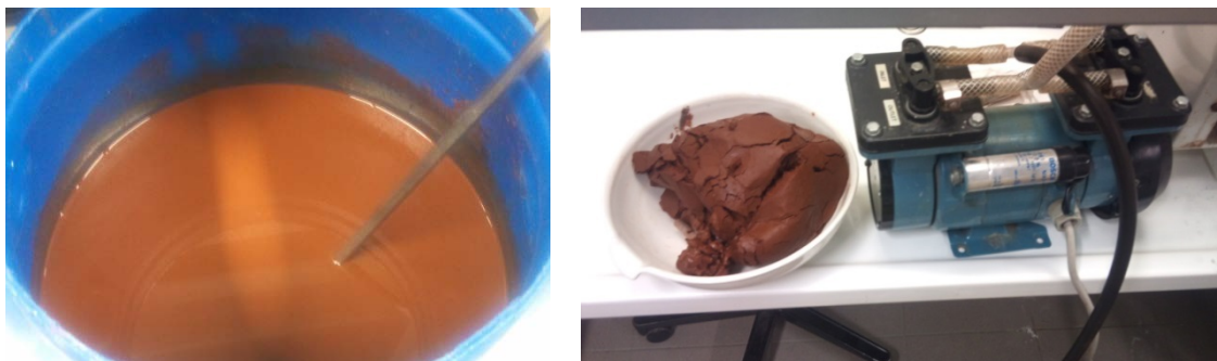
Abbildung 12: Metallhydroxide in Mutterlauge (li.) und nach der Filtration (re.)
