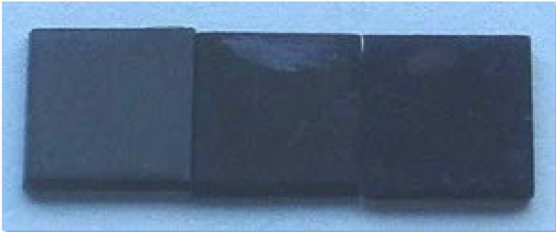
Abbildung 3: Proben des (von links) unbehandelten, einmal brünierten und dreifach brünierten TwinFire-Gate-Materials
