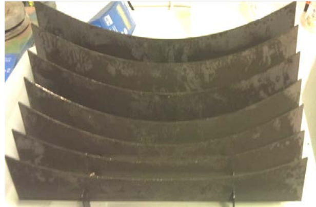
Abbildung 18: Brüniertes TwinFire-Gate nach der Beschichtung mit Nickelnitrat-Lösung
