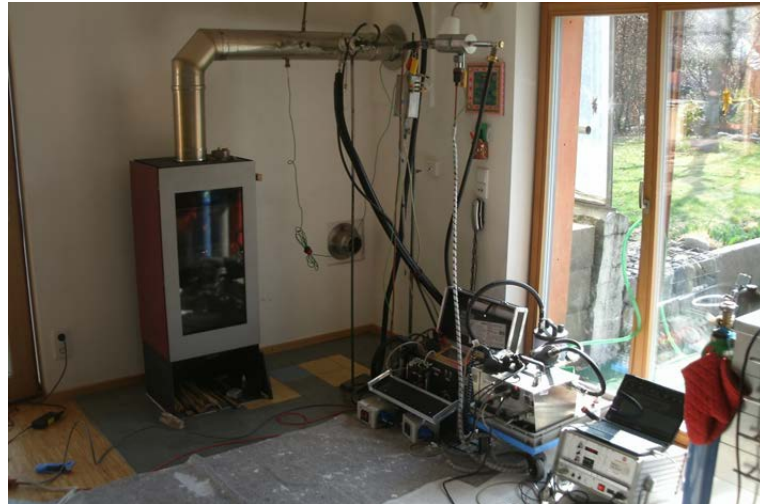
Abbildung 46: Aufbau der Messtrecke beim ausgewählten Privatbetreiber für die Feldmessung
