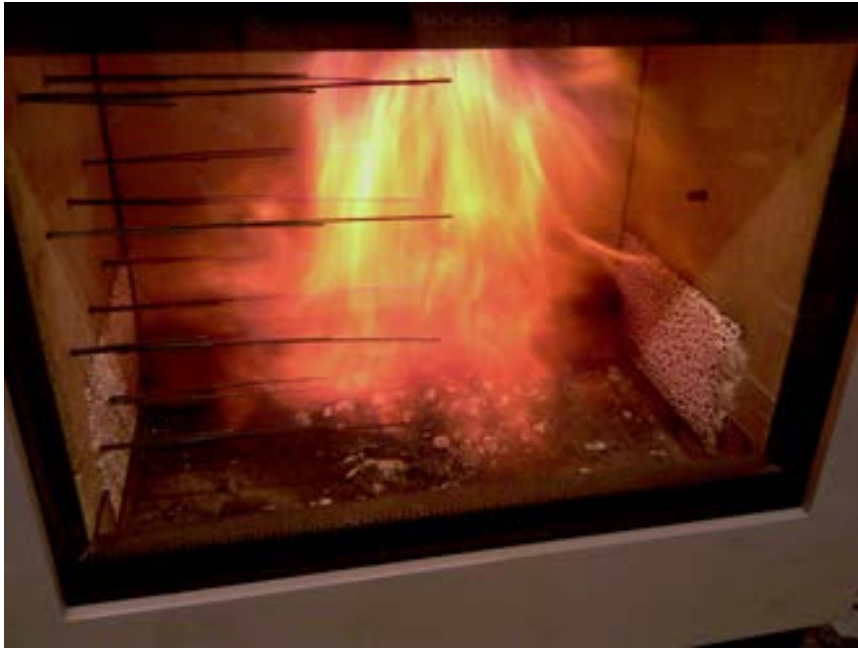
Abbildung 33: Fotografie des Versuchsaufbaus mit unbeschichteten \text{Al}_2\text{O}_3 -Schwämmen im unteren Brennraum
