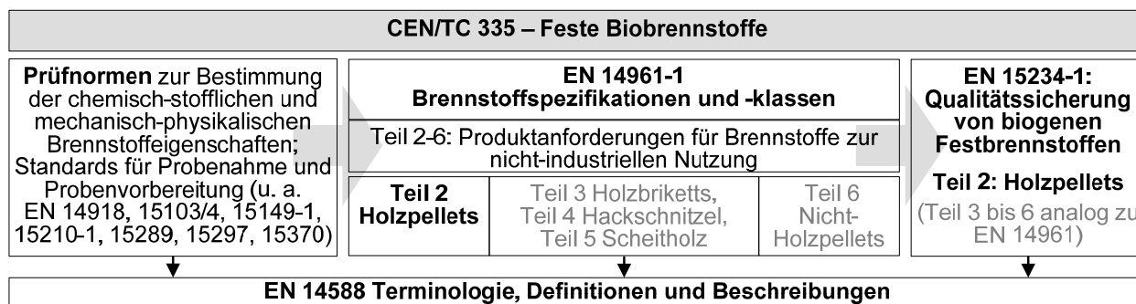
Abb. 2-2: Systematisierung relevanter EU-Normen für die Charakterisierung von Holzpellets
