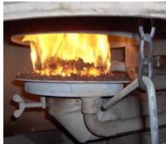
Abb. A-0-4: Funktionsskizze des Pelletti II SR 203 (oberes Bild), Prinzip der Brennstoff- und Luftzufuhr sowie der Ascheabfuhr im Feuerraum (unteres Bild links), Brennerretorte mit Pellets (Bild unten rechts) /2/, /172/
