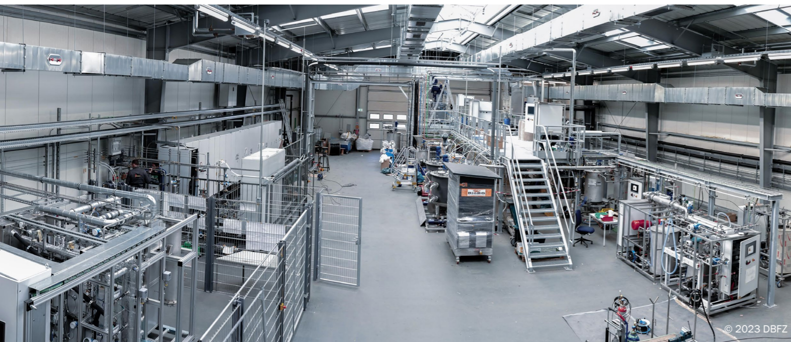
Abbildung 2: Pilotanlage für erneuerbares Methan aus biogenen Reststoffen und grünem Wasserstoff am Deutschen Biomasseforschungszentrum gemeinnützige GmbH in Leipzig
