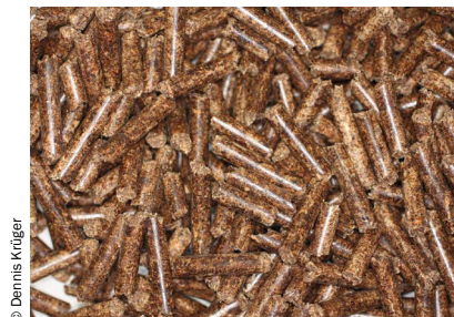
Abb. 3 Holzpellets mit 30% Rindenanteil
